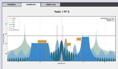
JAMMER SPECTRUM IN SKYDEL GUI
